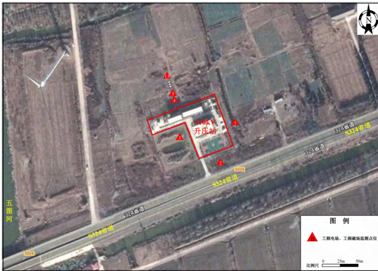
图 3.2-4 类比国信灌云 100MW 陆上风电场项目 110kV 升压站周围概况及监测点位示意图
