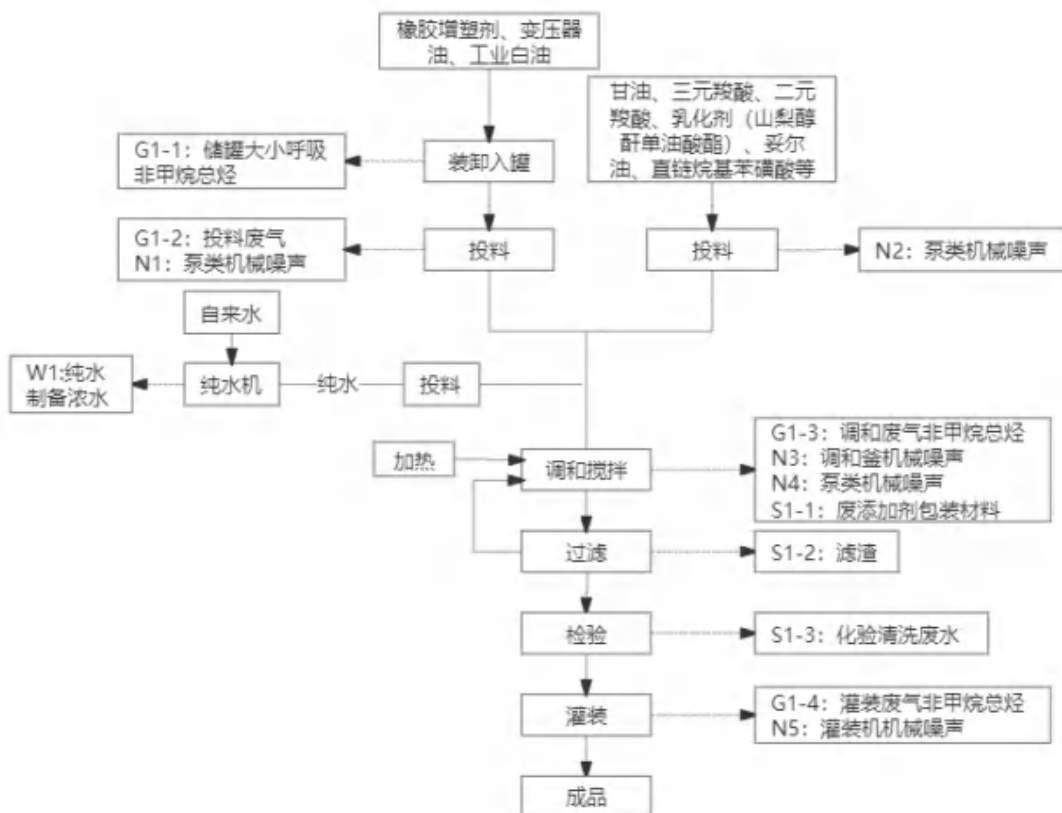
图 2-2.2 切削油生产工艺流程图
