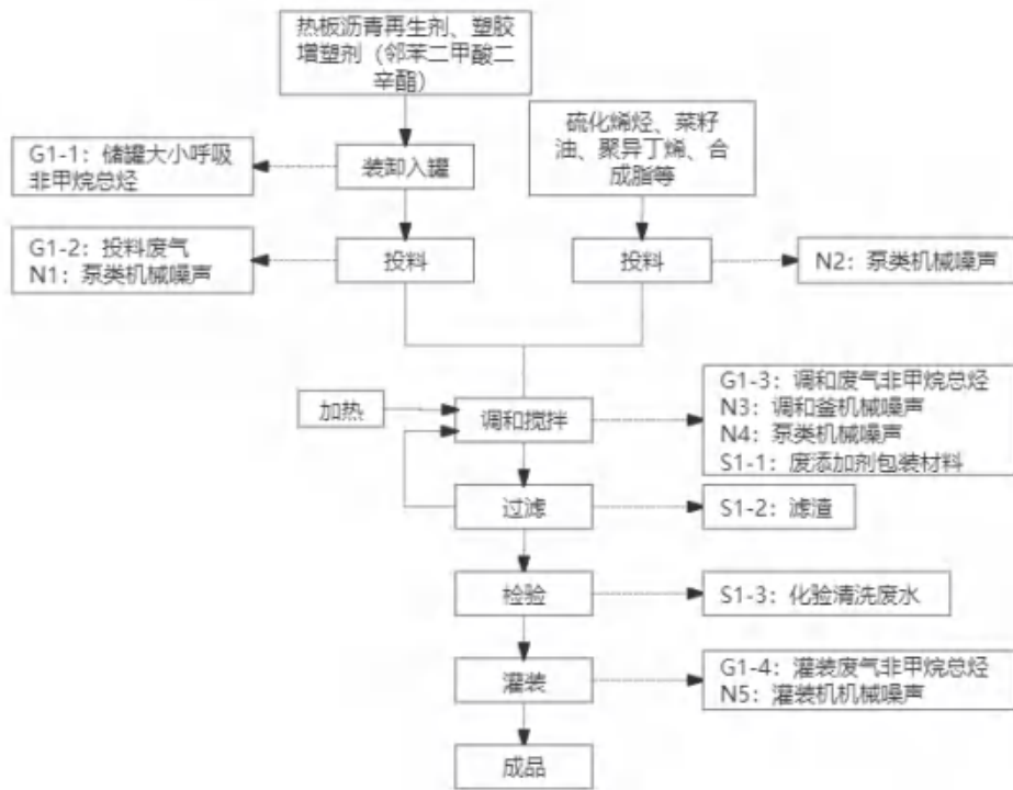
图 2-2.2 切削油生产工艺流程图
