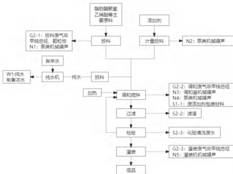
图 2-3 清洗剂生产工艺流程图
