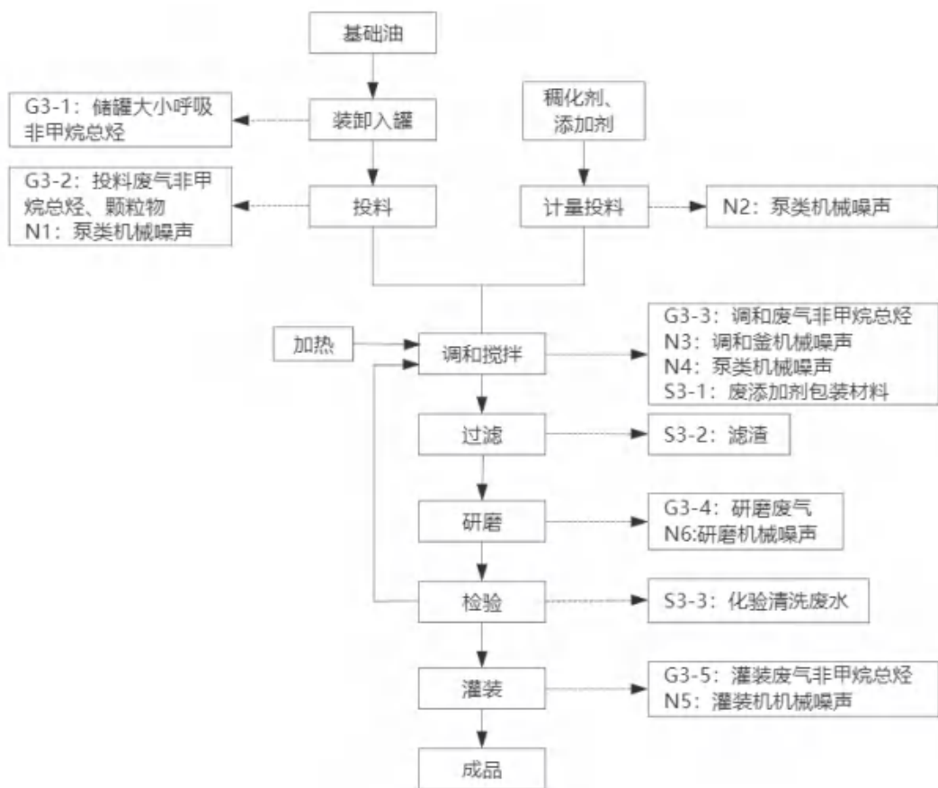
图 2-4 润滑脂生产工艺流程图
