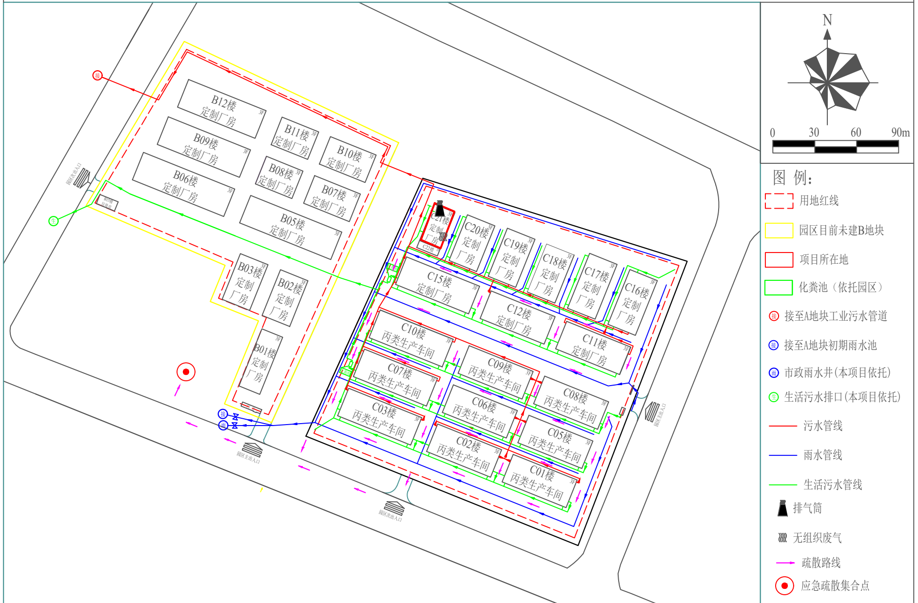
附图十二 事故污染物内部控制及应急疏散路径图（B+C地块）本项目所在地块
