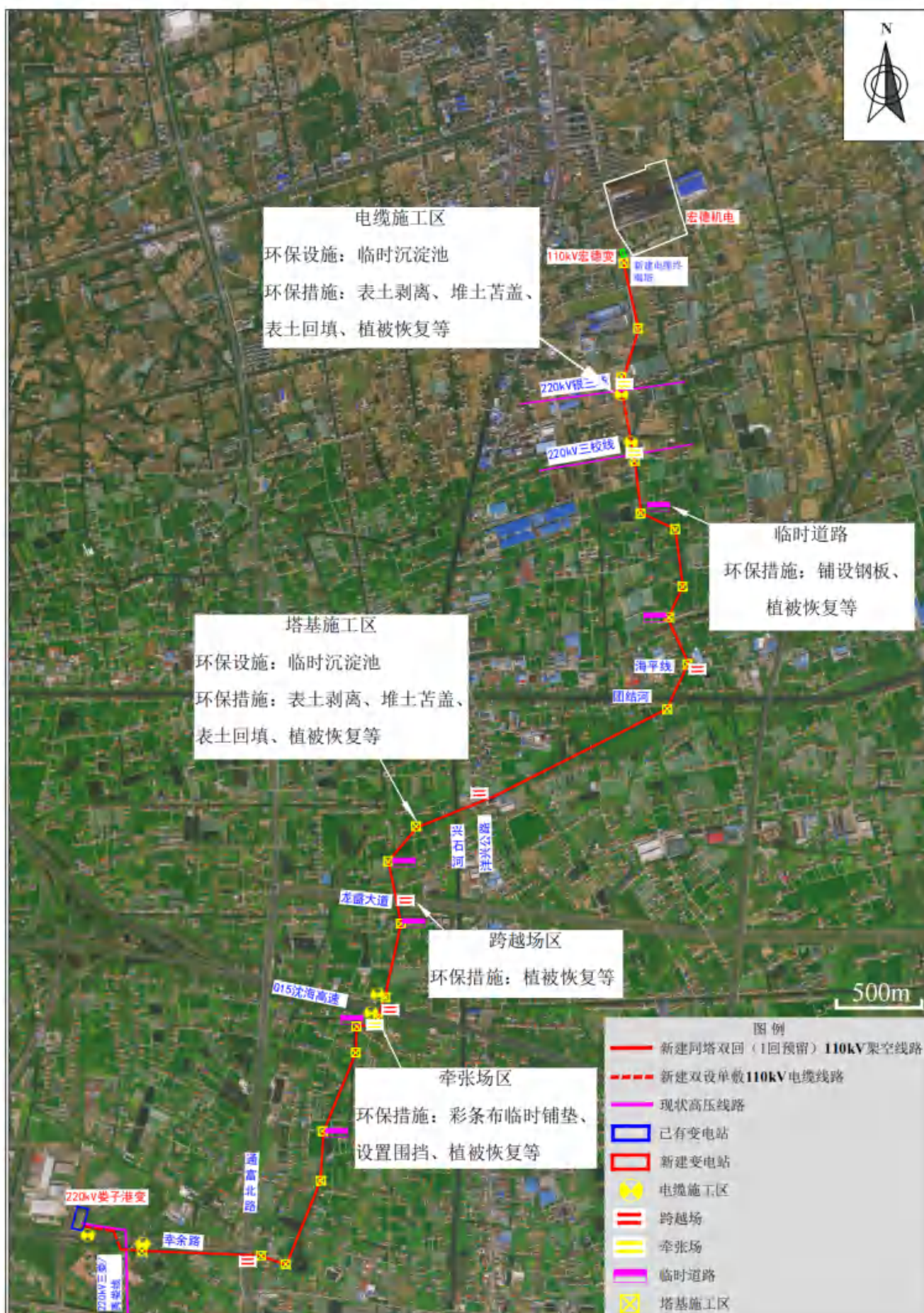
附图7 本项目施工期环保设施布置示意图
