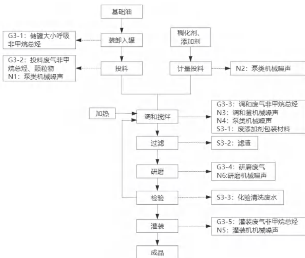
图 2-4 润滑脂生产工艺流程图
