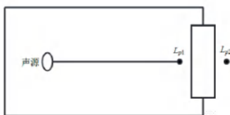
图 4-2 室内声源等效为室外声源图例
