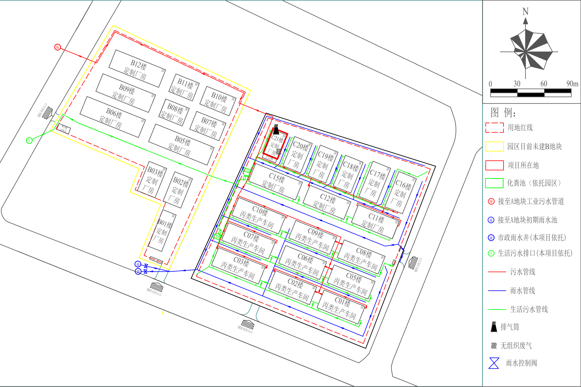
附图十 项目所在园区雨污管网、公辅工程图（B+C地块）本项目所在地块
