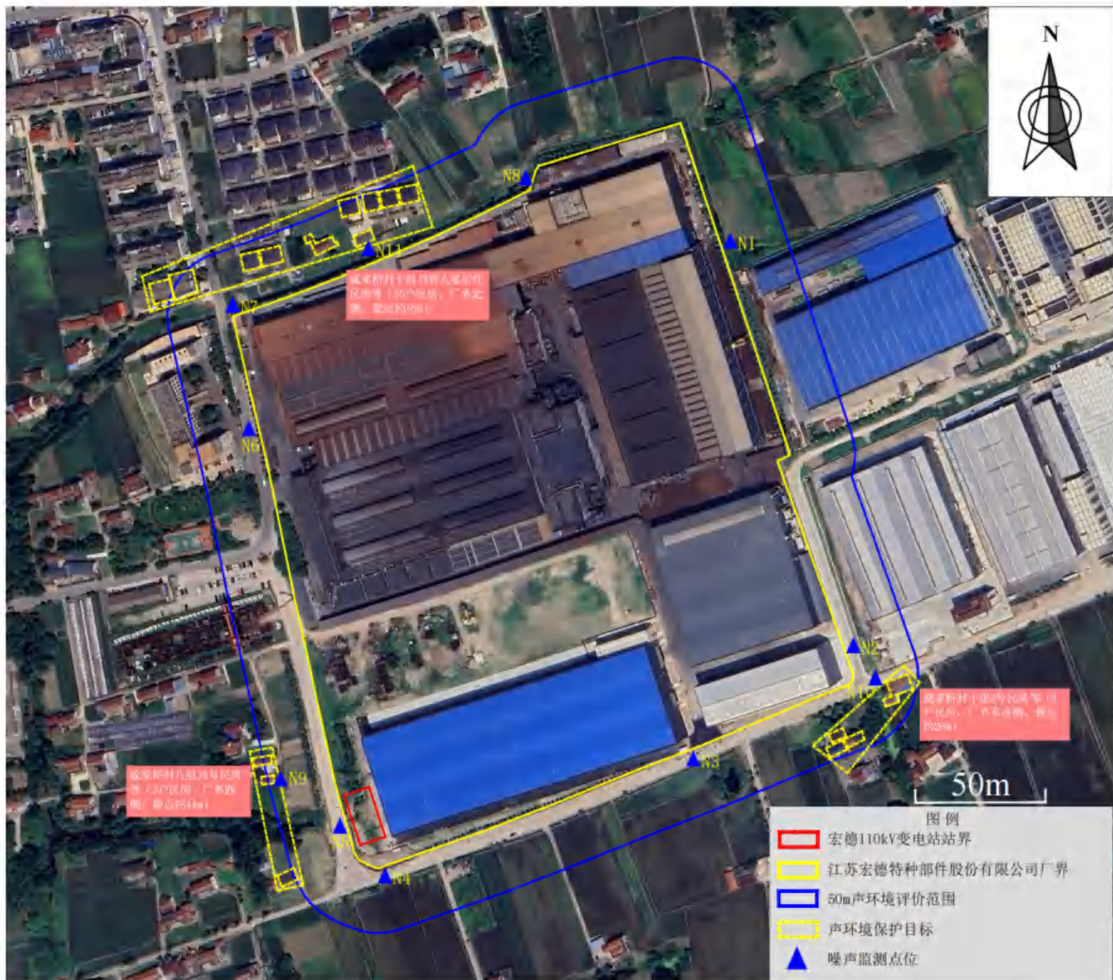
附图6-1本项目宏德110kV变电站评价范围、敏感目标及监测点位示意图（声环境）
