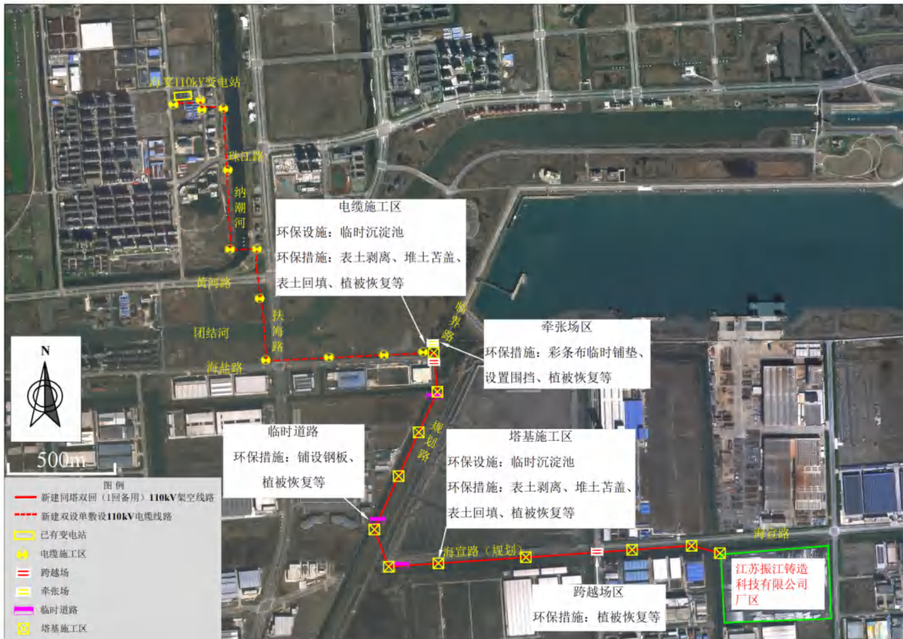
附图9 本项目施工期环保设施布置示意图
