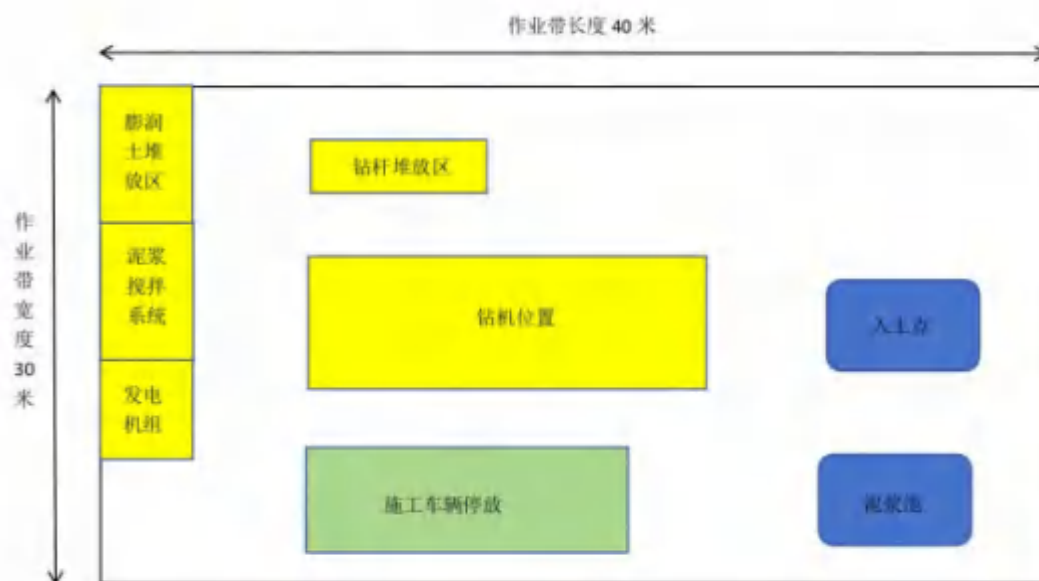
图 2-4 直埋开挖布置图
