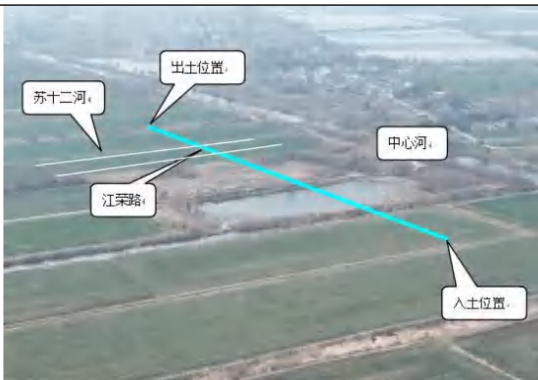
图 2-19 规划苏十二河定向钻穿越
