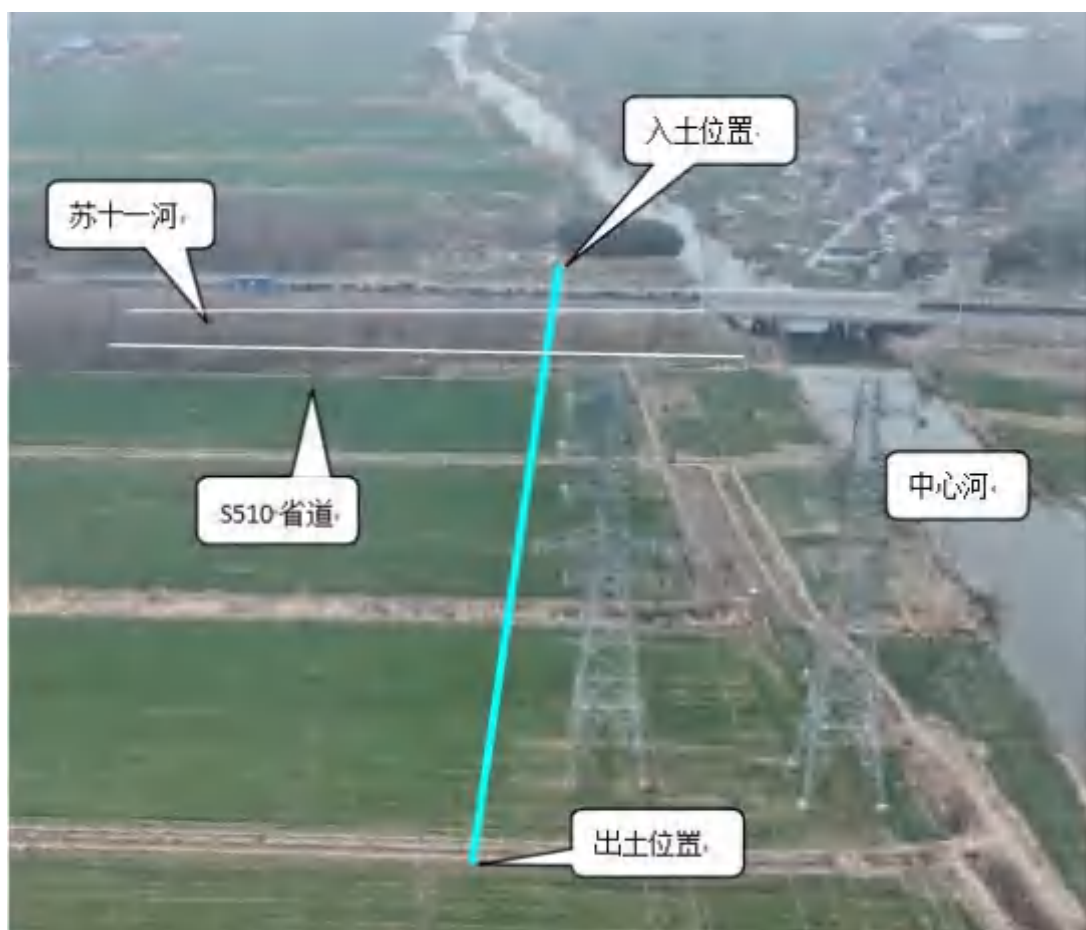
图 2-20 规划苏十一河定向钻穿越
