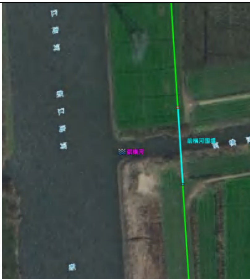
图 2-9 开挖方式穿越前横河
