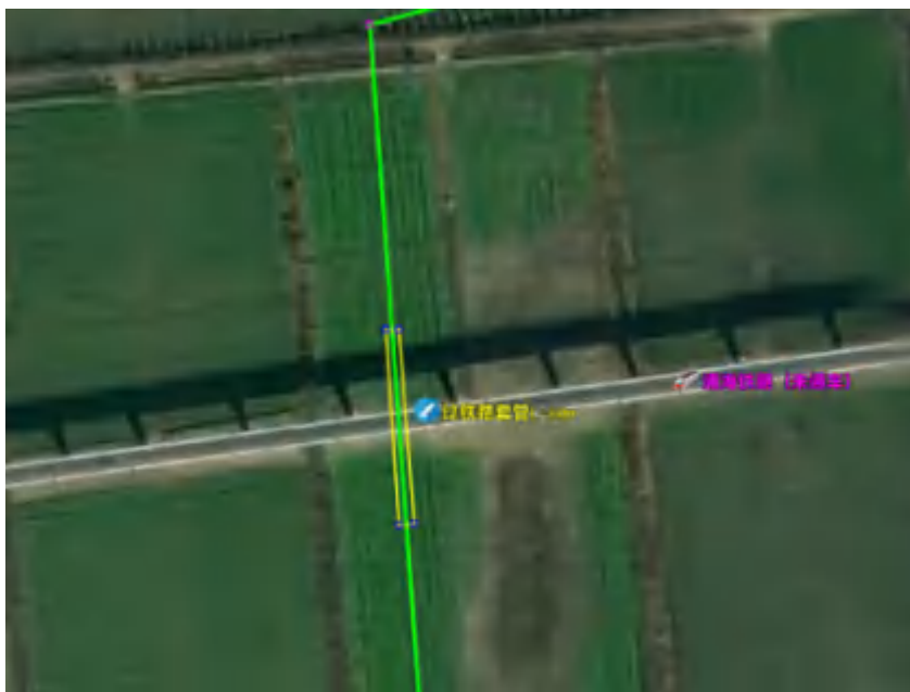
图 2-10 开挖方式穿越通海铁路
